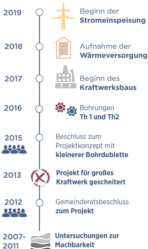
Das Projekt wurde seit 2007 intensiv vorbereitet mit Daten aus Kohlenwasserstoffbohrungen, einer 3D-Seismik, Machbarkeitsstudien und Wirtschaftlichkeitssimulationen. 2011 war geplant, Erdwärme mit ca. 150°C zur Fernwärmeversorgung im Ort und zur Stromerzeugung in einem ORC-Kraftwerk mit 5 bis 6 MWel wirtschaftlich zu nutzen.
